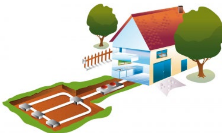
Slika 6: Prikaz delovanja toplotne črpalke zemlja-voda
